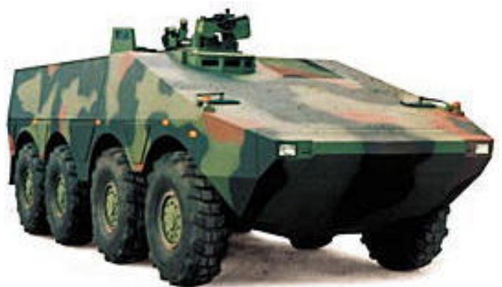
Foto Nro 05: Prototipo del vehículo trinacional. Se ve el módulo básico y el módulo operativo estándar (nótese el parecido con el Piraña IV)
